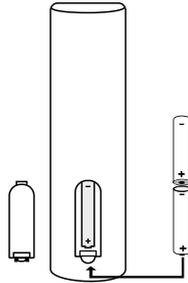
Wechseln Sie die Batterien, wie auf der Abbildung beschrieben, aus:
