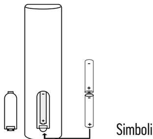
Sostituire le batterie come mostrato nell'illustrazione:
